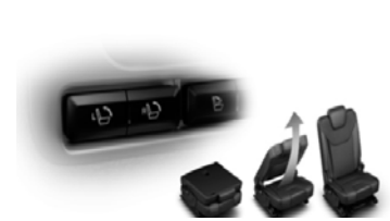
Električno podiranje sedežev v tretji vrsti
